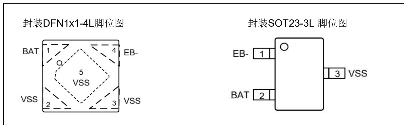
图 2. HCR2691封装脚位图 (顶部)
